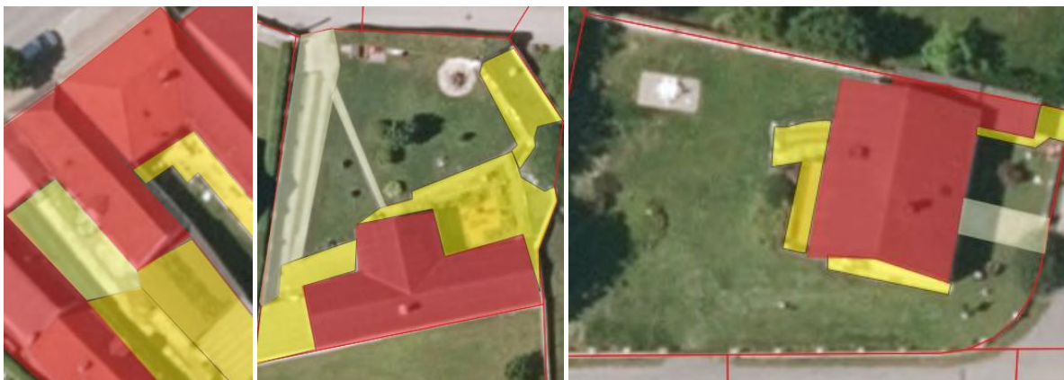
Abbildung 173: Teilflächendifferenzierung für Referenzgrundstücke der Grundstücksarten „Ortskern“ (links), „Einfamilienhaus dichte Bebauung“ (mitte), „Einfamilienhaus extensive Bebauung“ (rechts); Datenquelle: GeoDaten Burgenland - geodaten.bgld.gv.at sowie eigene Darstellung aus dem Fallbeispiel
