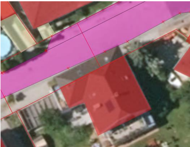
Abbildung 103: Fehlerhafte Teilflächendigitalisierung; Datenquelle: GeoDaten Burgenland - geodaten.bgld.gv.at sowie eigene Darstellung aus dem Fallbeispiel
