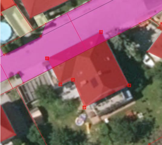
Abbildung 104: Korrektur Teilflächendigitalisierung: Dachfläche und Straße korrekte Fläche aufgenommen (links) bzw. Projektion der Dachfläche auf Straßenniveau (rechts); Datenquelle: GeoDaten Burgenland - geodaten.burgenland.gv.at sowie eigene Darstellung aus dem Fallbeispiel
